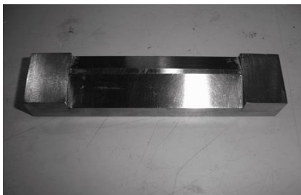
Figura 115 - Extendedor para obtener películas de pintura de espesor uniforme - Fuente: Tecnología de Pinturas y Recubrimientos (Carlos Giudice – Andrea Pereyra, Ed. UTN)
