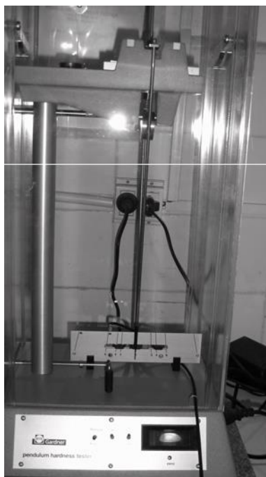
Figura 129 - Durómetro de péndulo - Fuente: Tecnología de Pinturas y Recubrimientos (Carlos Giudice – Andrea Pereyra, Ed. UTN)
