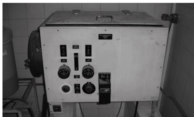
Figura 126 - Cámara de Humedad y Temperatura Controladas - Fuente: Tecnología de Pinturas y Recubrimientos (Carlos Giudice – Andrea Pereyra, Ed. UTN)
