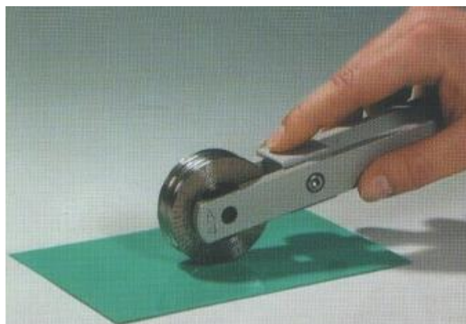
Figura 116 - Determinación del espesor de película húmeda a través de la rueda - Fuente: Tecnología de Pinturas y Recubrimientos (Carlos Giudice – Andrea Pereyra, Ed. UTN)
