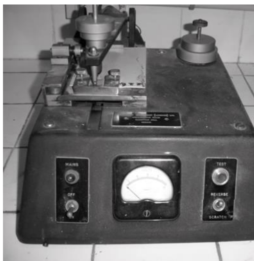
Figura 128 - Medidor de resistencia al rayado (“Scratch test”) – Fuente: Tecnología de Pinturas y Recubrimientos (Carlos Giudice – Andrea Pereyra, Ed. UTN)
