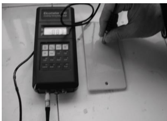
Figura 119 - Medidor de espesor de película seca. Ensayo no destructivo: efecto magnético-inductivo - Fuente: Tecnología de Pinturas y Recubrimientos (Carlos Giudice – Andrea Pereyra, Ed. UTN)
