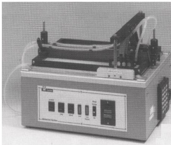
Figura 127 - Resistencia a la abrasión; desgaste por fricción - Fuente: Tecnología de Pinturas y Recubrimientos (Carlos Giudice – Andrea Pereyra, Ed. UTN)
