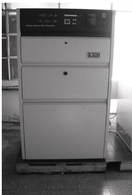
Figura 124 - Intemperiómetro ("Weather-Ometer") con luz de xenón - Fuente: Tecnología de Pinturas y Recubrimientos (Carlos Giudice – Andrea Pereyra, Ed. UTN)
