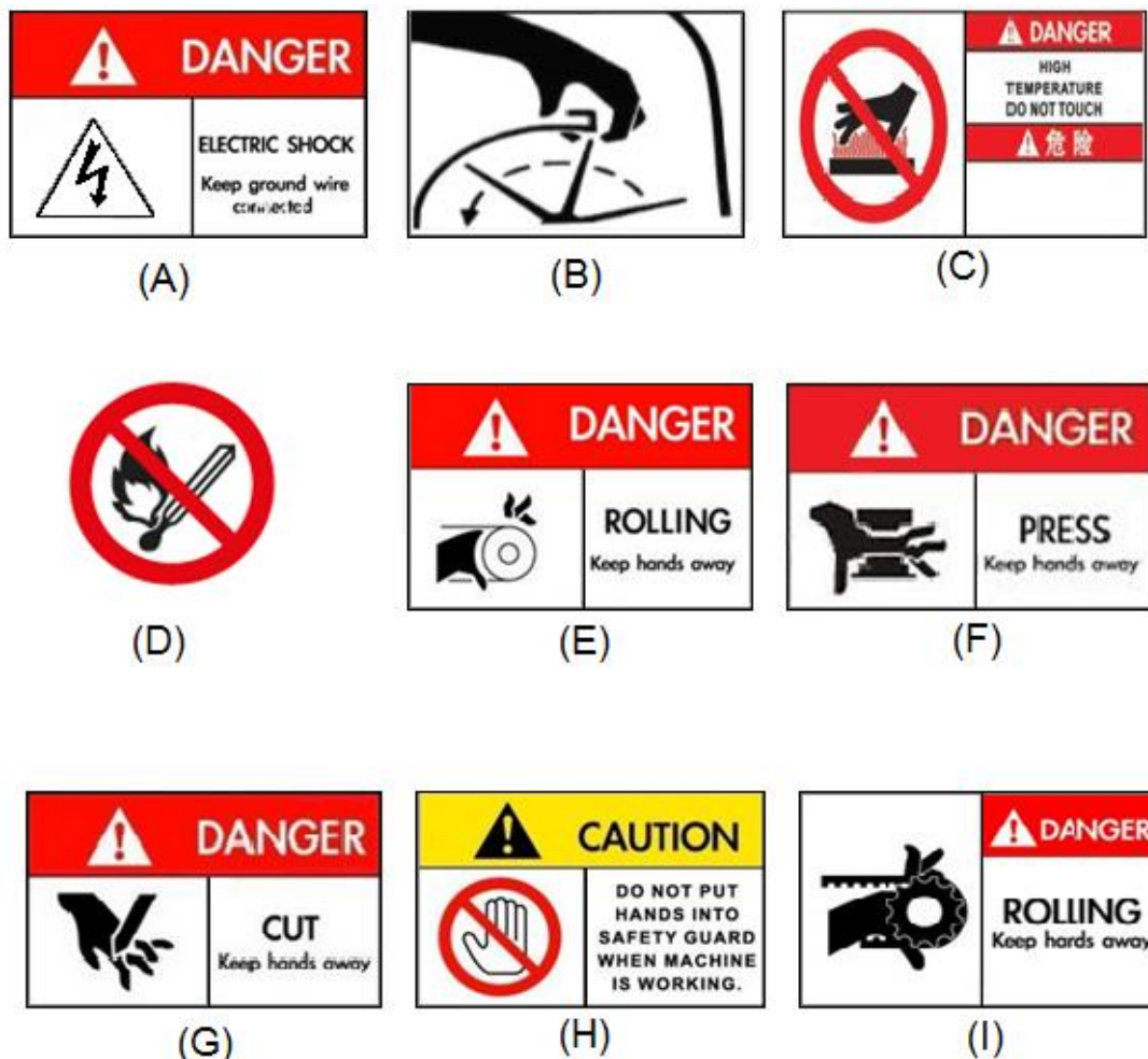
Figura 135 - Señalización en Maquinarias
