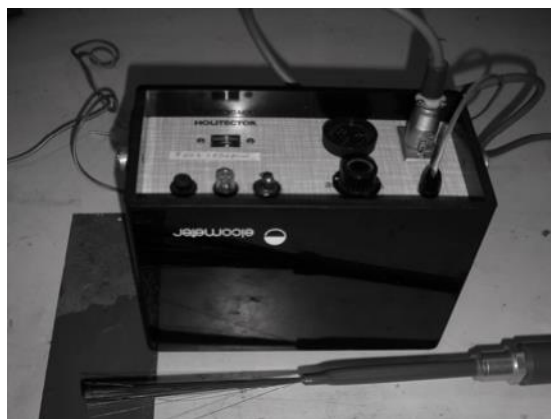
Figura 121 - Detector de poros en películas sobre sustratos metálicos por descarga eléctrica - Fuente: Tecnología de Pinturas y Recubrimientos (Carlos Giudice – Andrea Pereyra, Ed. UTN)
