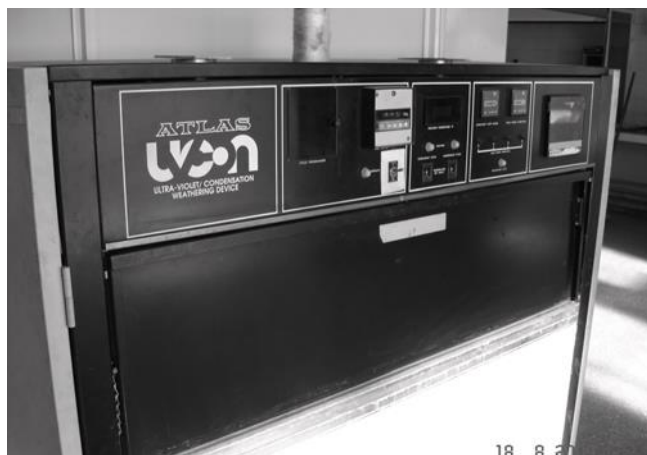
Figura 125 - Cámara de envejecimiento por UV - Fuente: Tecnología de Pinturas y Recubrimientos (Carlos Giudice – Andrea Pereyra, Ed. UTN)
