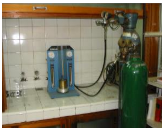
Figura 131 - Equipo para determinar el Índice de Oxígeno Límite - Fuente: Tecnología de Pinturas y Recubrimientos (Carlos Giudice – Andrea Pereyra, Ed. UTN)
